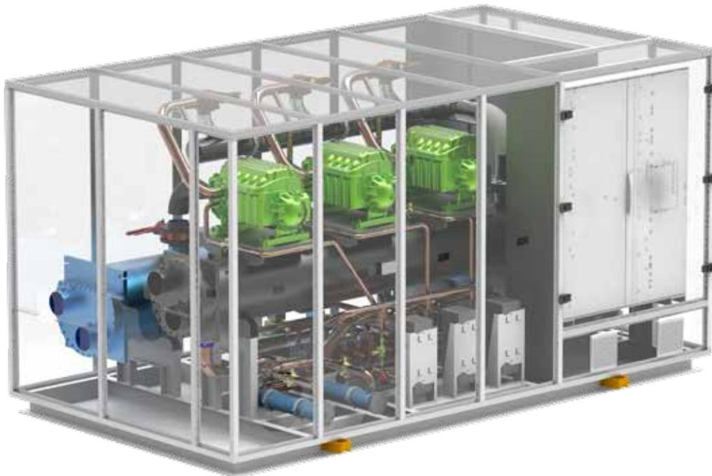
Las unidades de la serie RWH Ka-Kh-Ke son enfriadoras de líquido y bombas de calor que funcionan con gases R134a, R1234Ze y R513A refrigerados por agua y están equipadas con intercambiadores de carcasa y tubo, compresores de tornillo semi herméticos. En función de la potencia frigorífica requerida, están disponibles en versiones monocompresor o multicompresor con 1 y 2 circuitos frigoríficos independientes y doble circuito hidráulico.
