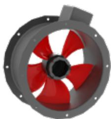
Le ventilateur d'expulsion du réfrigérant s'active quand le détecteur de fuites capte une présence de réfrigérant à l'intérieur du compartiment des compresseurs. L'air propre est poussé à l'intérieur et par cette circulation le mélange d'air et de réfrigérant potentiellement explosifs, formé à l'intérieur du compartiment, est évacué. Le débit du ventilateur permet le complet remplacement de l'air en moins de 10 secondes.
