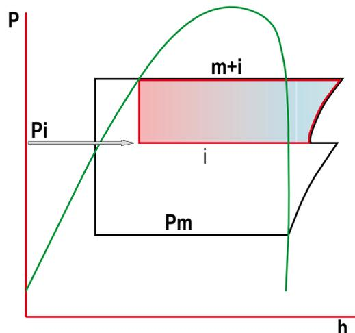
consente alla pompa di calore aria/acqua di produrre acqua calda fino a 65°C e la possibilità di lavorare fino alla temperatura ambiente di -20°C.
